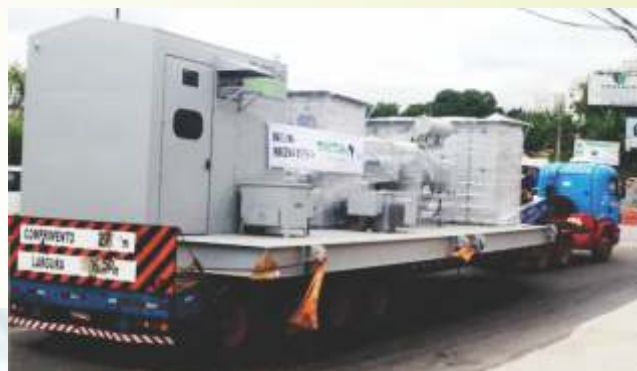
Eletrocentro para fixação sobre pilares.
